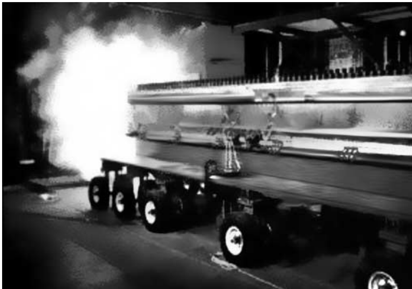
Рис. 6. Выстрел из экспериментальной рельсотронной установки Sandia National Research Laboratories на колесной платформе.
