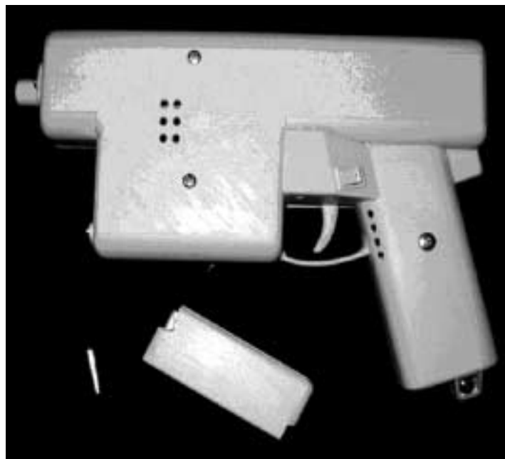
Рис. 3. Электромагнитный пистолет конструкции Евгения Васильева.
