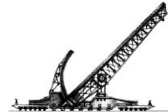
Рис. 1. Проект электромагнитной пушки Фашона и Виллепле (журнал «Техника молодежи» №5/1987).
